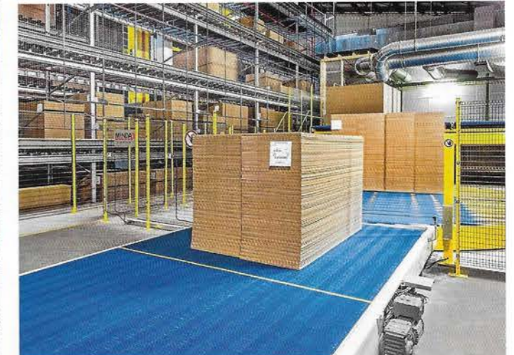
Ansicht des automatischen Formatlagers mit Förderstrecke.
