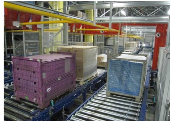
Nach erfolgreichem Passieren der Kontrollen wird der GLT auf Stetigförderern bis zum Einlagerstich transportiert.
